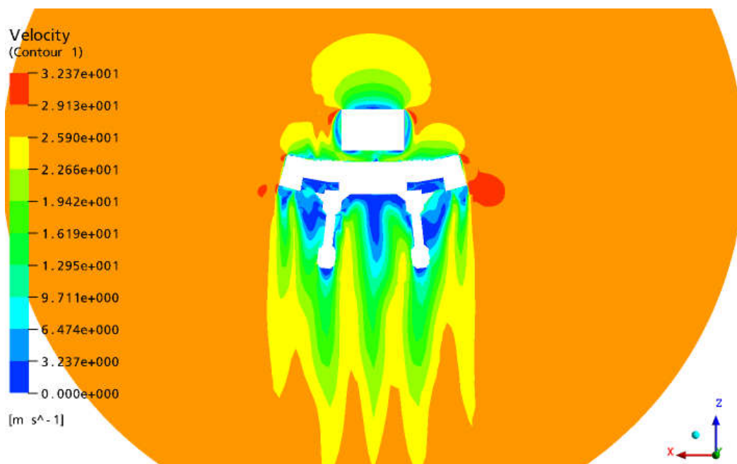
Рис. 3. Поле мгновенной скорости в сечение (ZX) при Y=20м
